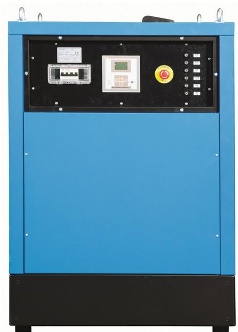
**Acier, peinture par poudre RAL5015, pour assurer une optimale résistance à la corrosion. Matériel acoustique résistant au feu, avec atténuation acoustique élevée. Facilité d'accès pour l'entretien ordinaire et extraordinaire grâce à portes d'accès verrouillables par clé. Silencieux d'échappement résidentiel, qui coupe 35dB. 4 crochets de levage. Aspiration air par le bas au côté opposé d'échappement, expulsion air côté échappement haut et au-dessous.**
